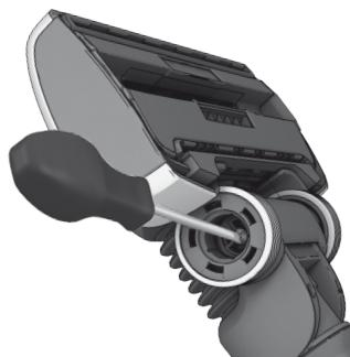
Odkręć oś i oczyść wszystkie części. Włożyć części z powrotem, wykonując czynności w odwrotnej kolejności.
