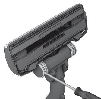
Če sta se kolesci zataknili, ju očistite tako, da z majhnim izvijačem odstranite njuna pokrovčka.
