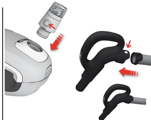
**Вставте шланг** (чтобы снять его, нажмите кнопки замка и вытяните).
