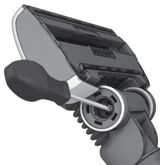
Odmontujte os kolieska a vyčistite všetky časti. Súčasti znova zložte v opačnom poradí.
