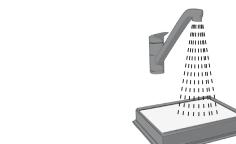
**Czyszczenie filtru wylotowego, który można oplukiwać wodą**
