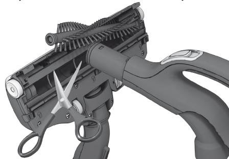
Wyjmij szczotkę rolkową i usuń zaplątane nitki i włókna, przecinając je nożyczkami. Oczyść ssawkę, używając uchwytu węża. Włożyć części z powrotem, wykonując czynności w odwrotnej kolejności.
