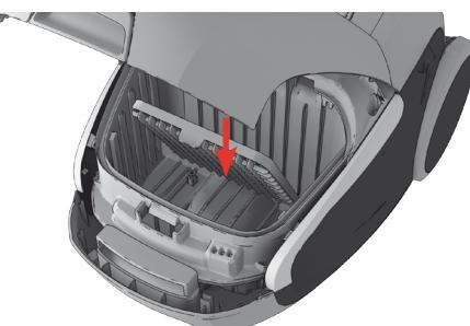
**Filter motora vymeňte, keď je špinavý alebo po každej piatej výmene vrecka s-bag®**. Zatlačte držiak filtra nadol a vytiahnite ho. Vymeňte filter a zavorte kryt.
