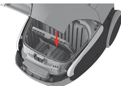
**Nomainiet motora filtru, kad tas ir netirs, vai pēc katrā piektā s-bag®.** Nospiediet filtra turētāju uz leju un izvelciet to. Nomainiet filtru un aizveriet vāku.
