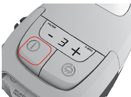
**Vysávač zapnite/vypnite** stlačením VYPÍNAČA.
